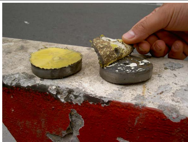
Campioni di condotta metallica rivestita con guaina di spessore insufficiente ed impregnata in difetto di resina
