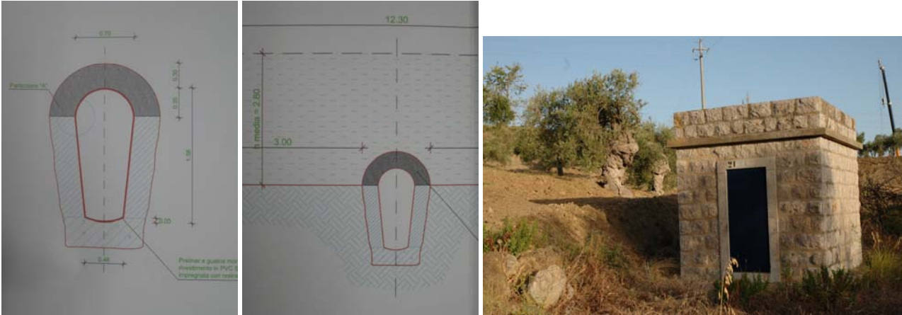
La sezione del canale, la situazione di interrimento e la veduta di superficie, in corrispondenza di un torrino di ispezione
